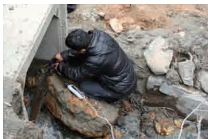
同じ場所で水の PH と ORP (酸化還元電位) を計測
